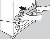
取り付けるときは、圧縮機上部のブッシュに蒸発皿取手部のボスを差し込み、蒸発皿の取手部が冷凍庫本体に当たるまで押し込んでください。
