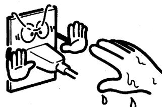
電源プラグを抜くときは、先端のプラグを持って行ってください。コードを引っ張つて抜くと芯線の一部が断線して発熱、発火の原因になります。
