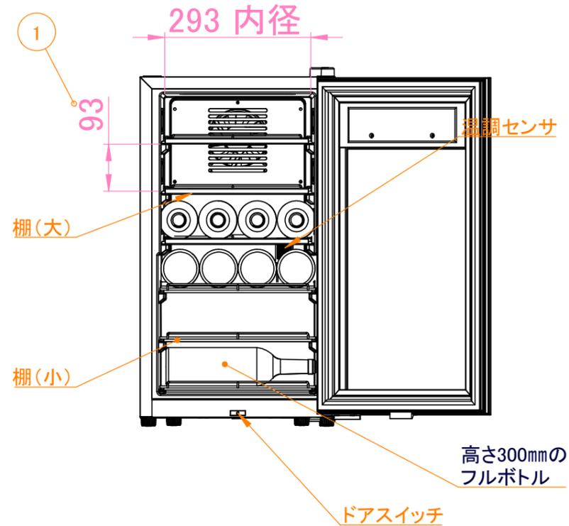
ドア開時の最大寸法 890mm
